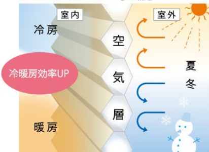
ハニカムスクリーン「ブレア」の構造
